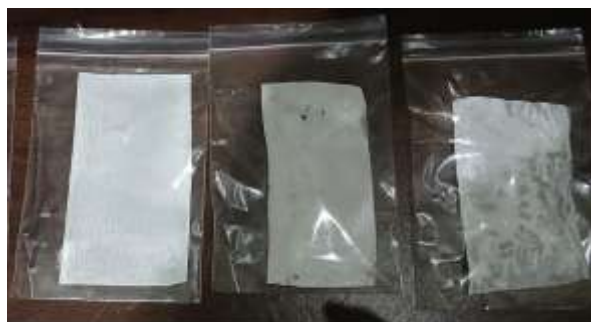
Gambar 2. Visualisasi fisik membran: (a) membran CF, (b) membran CF/CS, dan (c) membran CF/Cs/Al-PAA
